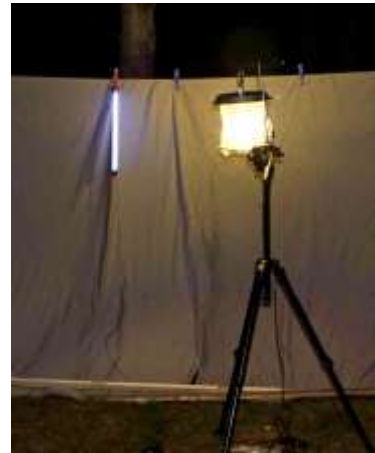
Lampe UV et lampe à vapeur de mercure
